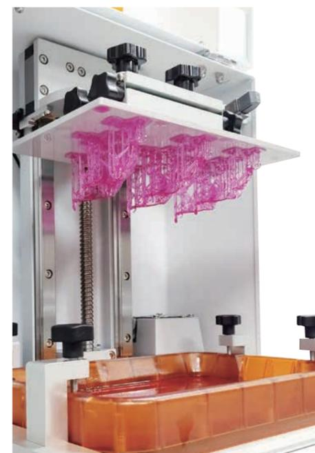
新しく開発した材料で従来のキャスト用材料より燃焼性をさらに向上しました。
